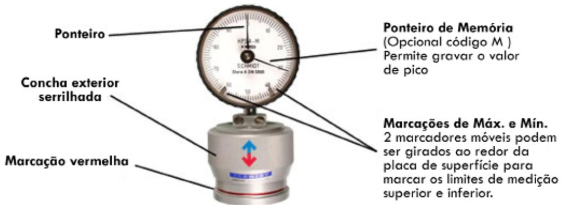
Para medir a rigidez, o anel de mola exterior é pressionado para baixo, até a borda do anel chegar à marcação colorida do encaixe. Isso garante uma pressão constante e impede erros de medição.
